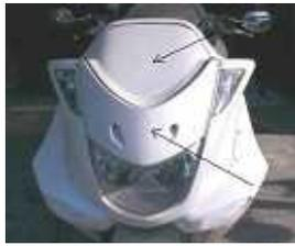
1、ノーマルのスクリーンを外し、矢印のカバーを外します。(左上図)
