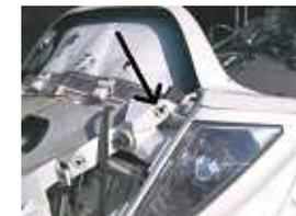
4、上側のネジの位置は、ノーマルのネジ穴を使用します。(右下図)
